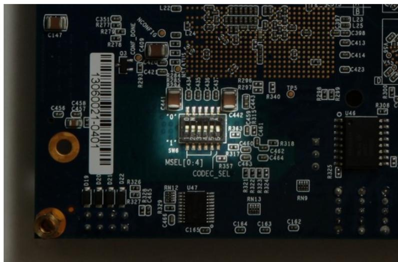
ボードの裏側、DIP switch がハイライトされています。右端を除くすべてのスイッチが上に押し上げられます。
