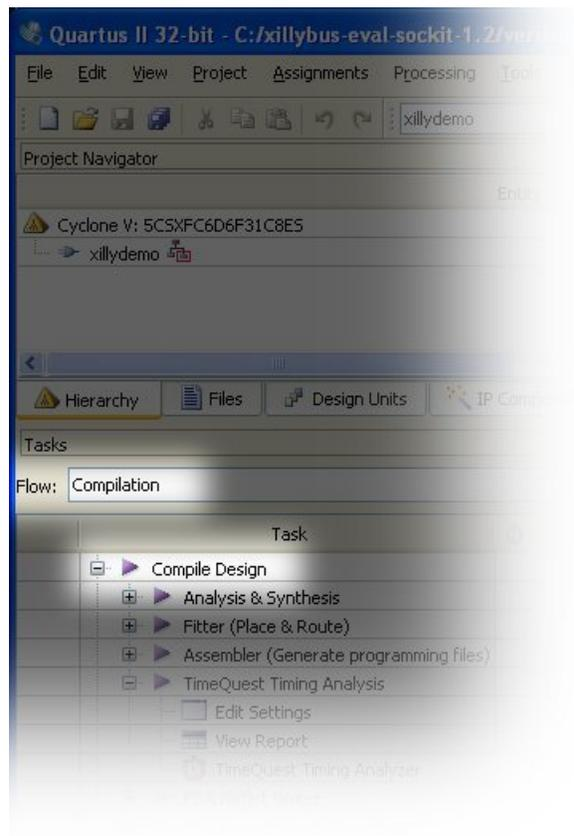
プロセスは約 100 の警告を生成しますが、“Full Compilation was successful”. 重大な警告が生成されますが、エラーは許容されません。また、compilation の後で、“Timing requirements not met” (332148) という警告がないことを確認することは常に必須です。これは特に、Verilog/VHDL ソースに独自の変更を加えた後に design の compilation を実行する場合に当てはまります。
